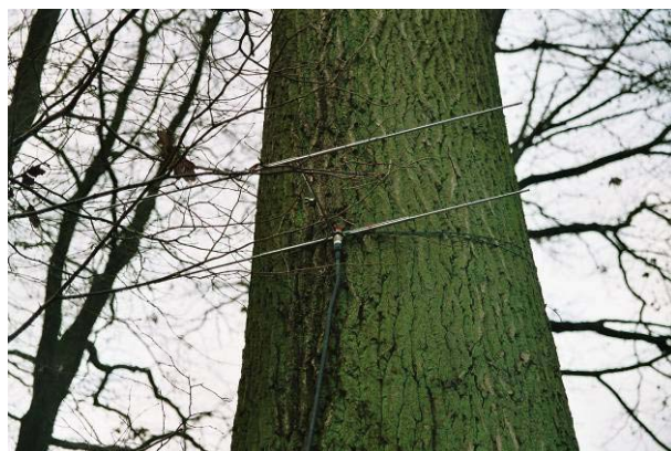
Abb. 51: Antenne einer Telemetriestation
