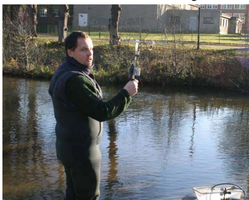
Abb. 52: Kontrollpeilung mit mobilem Empfangsgerät
